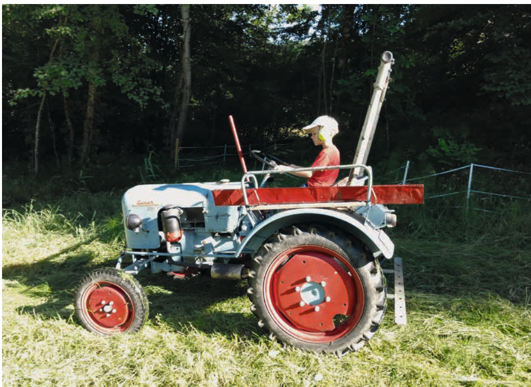
Abbildung 9: Museumsreife Technik, die aber noch funktioniert: Leichtgewichtige Schmalspurtraktoren mit Seitenbalkenmäher sind ideale Landschaftspfleger für kleine Flächen oder Ränder (Foto: Wolfram Adelman).
